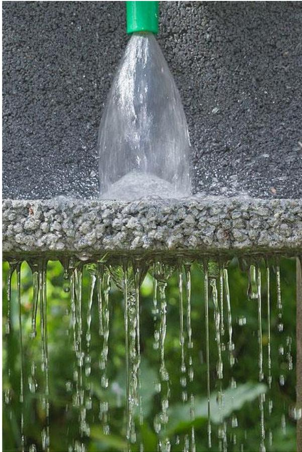
**Perméabilité : 224,5 l/min/m<sup>2</sup>** (sur une épaisseur de 4 cm)
